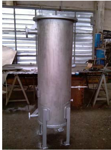
Fig. 4. Capsulă de presurizare utilizată în cadrul instalației de flotație
