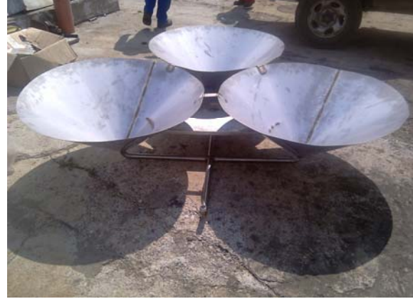
Difuzorii sistemului de fotație care se montează în decantorul lamelar
