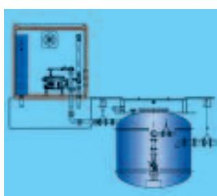
Sus: Vedere schematica a statiei cu vid, cu bazin ingropat si pompe de descarcare submersibile.
